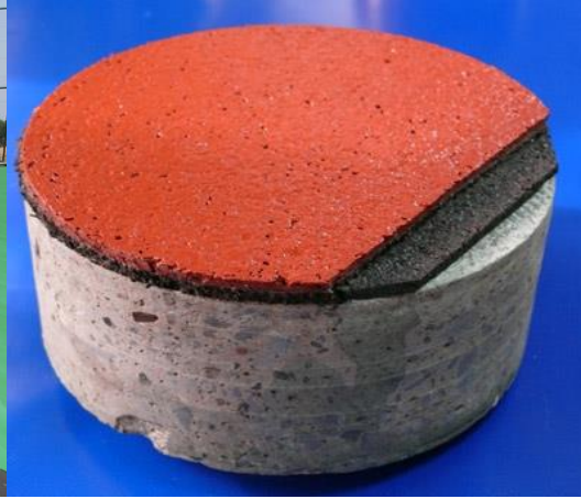
RUBBER ÜZERİ CUSHİON KATMANLI AKRİLİK DETAYI
