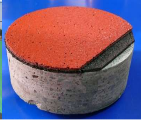
RUBBER ÜZERİ CUSHION KATMANLI AKRİLİK DETAYI
